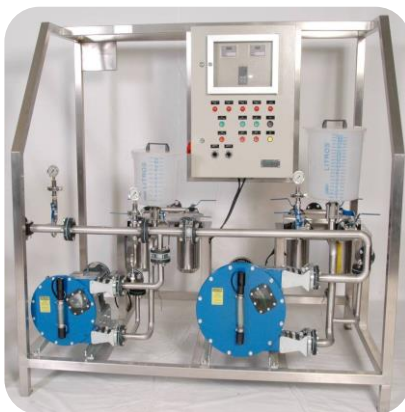
Skid 02 bombas peristálticas com provetas e estrutura em inox ligadas em SDCD .
