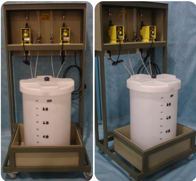
Skid 02 bombas dosadoras com provetas , estrutura em aço carbono com pintura epoxi , revestido em pp , tanque graduado com bacia de contenção incorporada .
