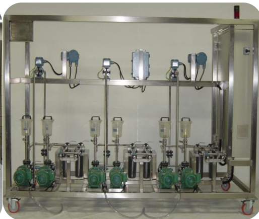
Skid 06 bombas dosadoras com provetas , sistema de 03 jogos com stand-by , estrutura em inox , painel elétrico , controle de vazão , conjunto de filtros e ligação via SDCD .
