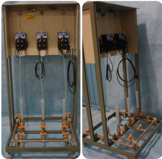
Skid 03 bombas dosadoras com provetas , estrutura em aço carbono com pintura epoxi , revestido em pp , filtros e rodízios .
