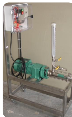
Skid 01 bomba fuso , com proveta , estrutura em inox , painel elétrico com inversor e rodízios.
