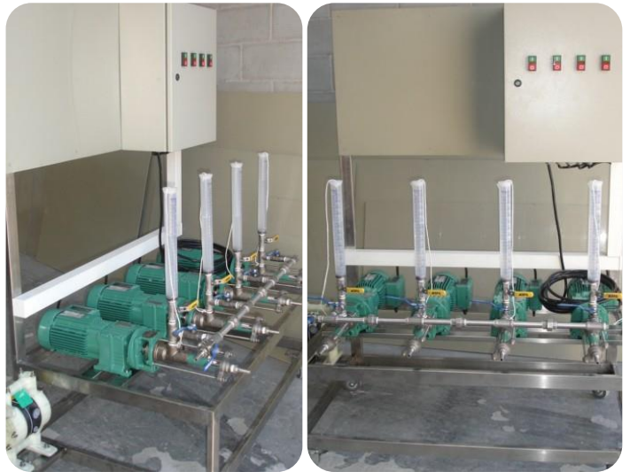
Skid 04 bombas fusos com provetas , estrutura em inox , painel elétrico , com bomba descarregamento , filtros e rodízios .
