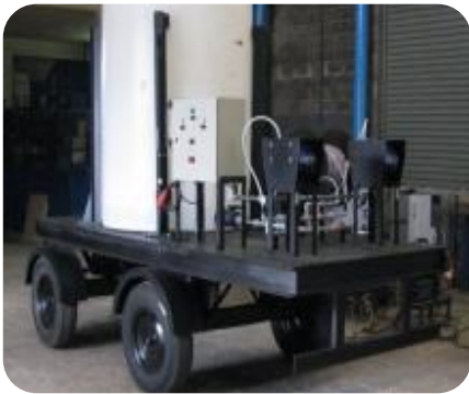
Sistema Móvel para Dosagem E Limpeza Quimica
