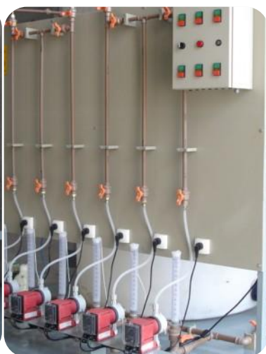
Skid 06 bombas dosadoras com provetas , sistema de Tancagem incorporado , sistema bomba de descarregamento , estrutura em aço carbono com pintura epoxi , painel elétrico , conjunto de valvulas by-pass .
