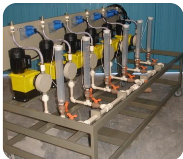
Skid 06 bombas dosadoras com provetas , estrutura em aço carbono com pintura epoxi .
