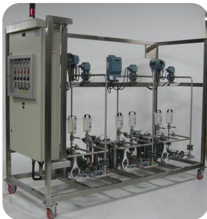
Skid 06 bombas dosadoras com provetas , sistema de 03 jogos com stand-by , estrutura em inox , painel elétrico , controle de vazão , conjunto de filtros e ligação via SDCD .
