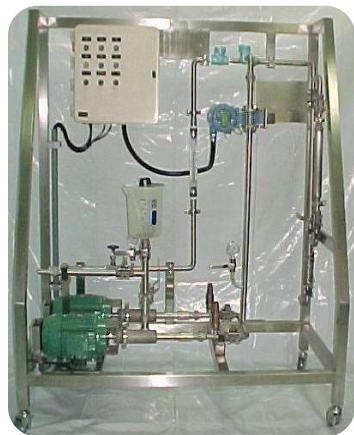
Skid 02 bombas dosadoras com provetas , estrutura em inox , painel elétrico e controle de vazão .
