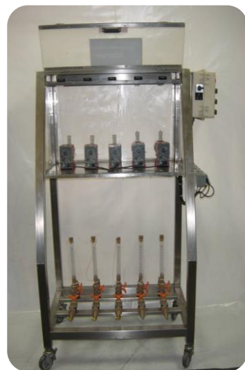
Skid 05 bombas dosadoras com provetas, estrutura inox, painel elétrico e revestimento pvc transparente .
