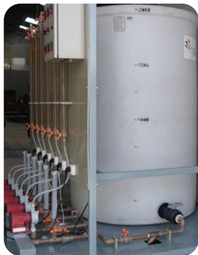
Skid 06 bombas dosadoras com provetas , sistema de Tancagem incorporado , sistema bomba de descarregamento , estrutura em aço carbono com pintura epoxi , painel elétrico , conjunto de valvulas by-pass .
