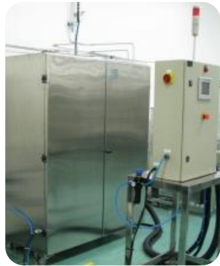
Sistema controle, mistura e dosagem para aparelhos cardiacos , com precisão de dosagem 0,0001.
