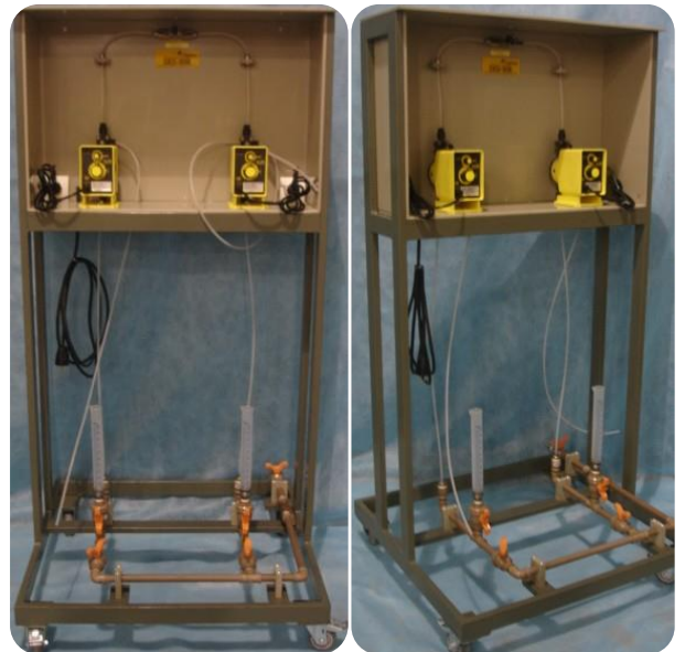
Skid 02 bombas dosadoras com provetas , estrutura em aço carbono com pintura epoxi , revestido em pp e filtro .
