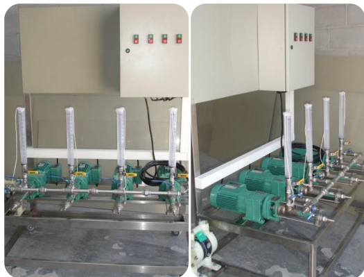
Skid 04 bombas fusos , com provetas , estrutura em inox , painel elétrico com inversores e rodízios.
